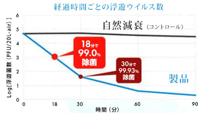
空気清浄機による浮遊ウイルスの抑制性能評価試験(25㎡空間) NUS-120型テスト機 試験番号 北生発2020 0205号
